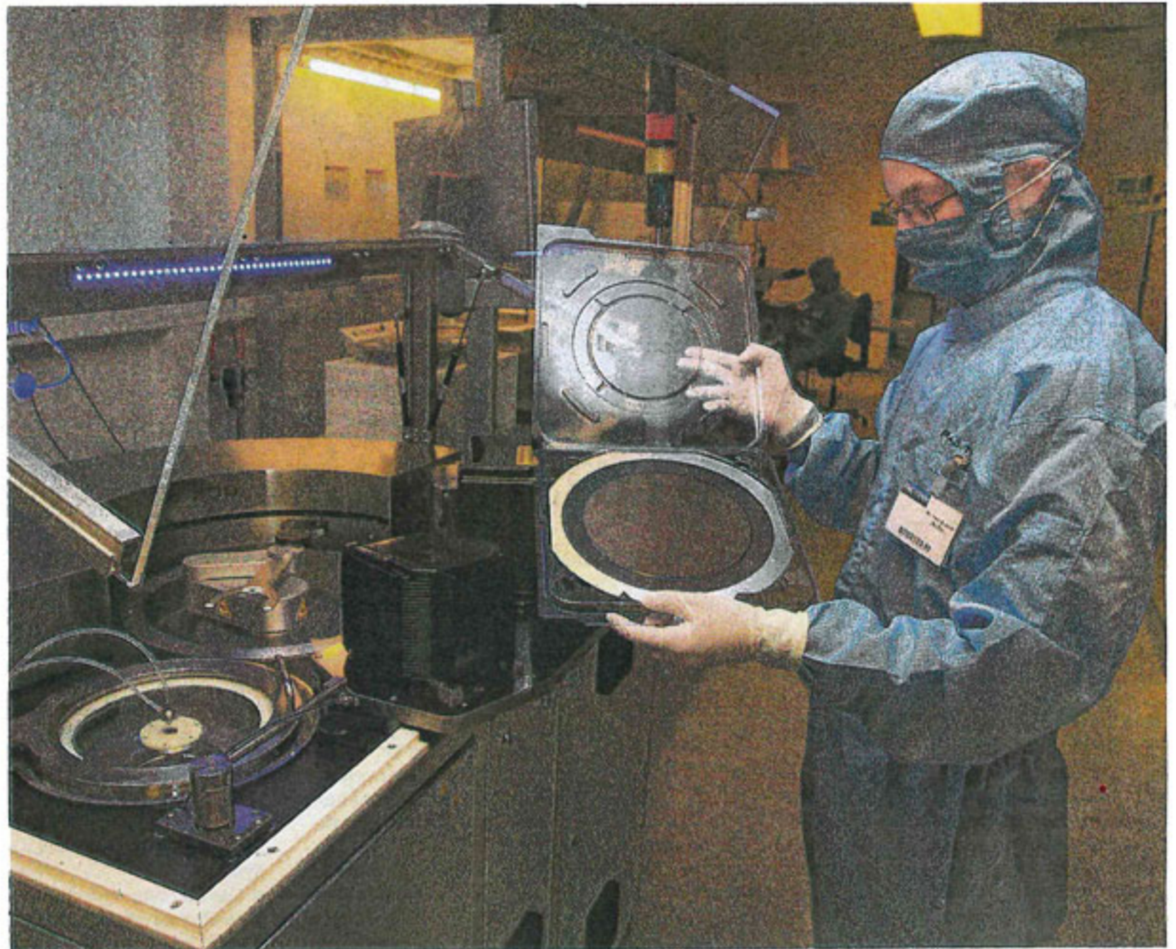
Michael Bücher begutachtet im Reinraum des Unternehmens eine Siliziumscheibe. Denn Pac Tech stellt nicht nur Maschinen her, sondern ist auch als Dienstleister tätig. Die Nauener versehen Mikrochips mit elektrischen Kontakten.
