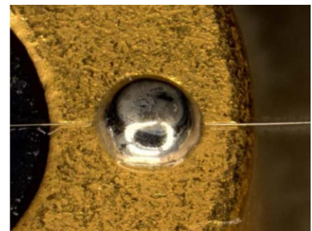
Abb. C3: SB 2 -WB Drahtverbindungen auf Sensorgehäuse
