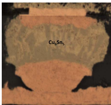
Abb. A3: IMC-Struktur einer 40 µm Cu-Pillar LAB Anbindung
