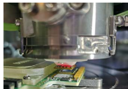
Abb. B2: Entfernung eines defekten POP mittels LAPLACE LAdB
